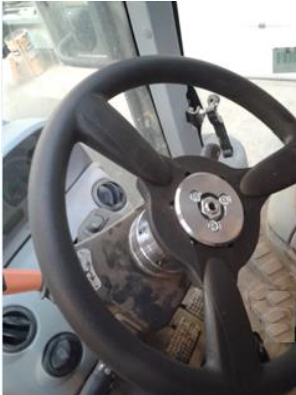
Figure 36. Direction manuelle avec volant Trimble détaché
