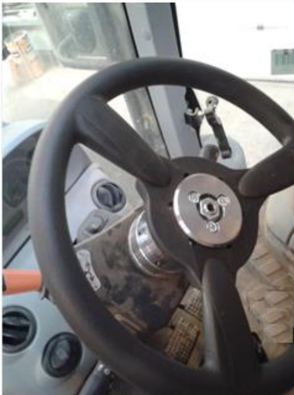
Abbildung 48 Manuelles Lenken mit losem Trimble Steering Wheel
