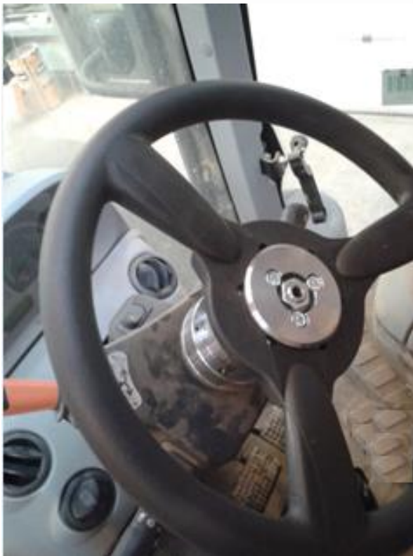
Figuur 12. Handmatig sturen met los Trimble Steering Wheel
