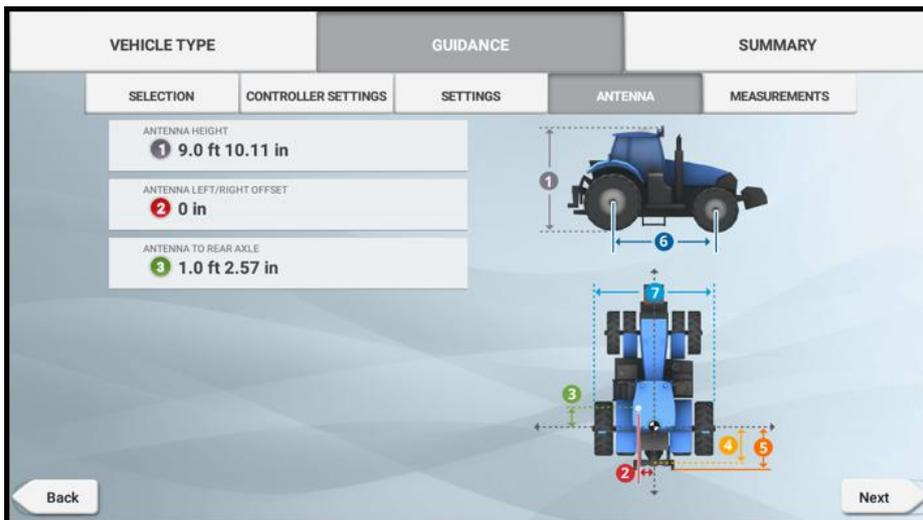
2. Geben Sie im Bildschirm „Vehicle Guidance – Measurements“ (Fahrzeugführung – Abmessungen) Werte für folgende Abmessungen ein:
