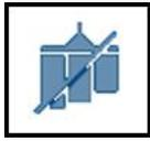
Die Funktion zur Aufzeichnung der bearbeiteten Fläche ist nicht verfügbar. Unzulässige Aufgabe, Problem mit Ausbringungseinstellungen oder Verbindung der Steuerung oder keine Kommunikation mit Spurführungscontroller.
