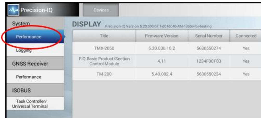
6. Drücken Sie die Zeile, die das zu aktualisierende Modul enthält. Drücken Sie zum Beispiel die Zeile mit Informationen zum Field-IQ-Modul. Drücken Sie die Pop-up-Schaltfläche **Update Module Firmware** (Modul-Firmware aktualisieren):
