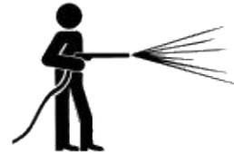
Stellen Sie den Schlauchdruck so gering wie möglich ein, und spritzen Sie unter einem Winkel von 45° bis 90°. Halten Sie mit der Düse des Dampfstrahlers den vom Hersteller empfohlenen Abstand zur Maschine ein.
