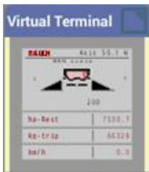
Um das minimierte Universalterminal-Widget größer anzuzeigen, drücken Sie die obere rechte Ecke des Widgets, und halten Sie sie gedrückt. Auf allen Seiten des Widgets werden Pfeile angezeigt. Drücken und ziehen Sie einen Pfeil, um das Widget größer anzuzeigen.
