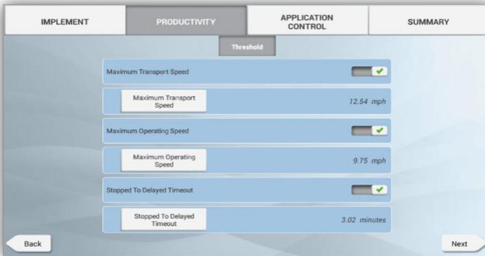
***HINWEIS** – Die Registerkarte „Productivity“ (Produktivität) ist nur sichtbar, wenn die Funktion **Enable Operators** (Fahrzeugführer aktivieren) eingeschaltet ist. Diese Funktion wird durch Drücken von **Settings** (Einstellungen) im Startbildschirm und Auswahl von **Users and Passwords** (Benutzer und Passwörter) aufgerufen.*
